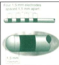
鉛電極末端四個接觸點各長 0.15 公分，間隔 0.15 公分
